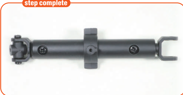
將 23-A 和 23-E 的螺絲孔對齊，然後使用 AP 螺絲 從上下方向固定兩個位置。請勿過度鎖緊 AP 螺絲，以免 23-E 無法轉動。
